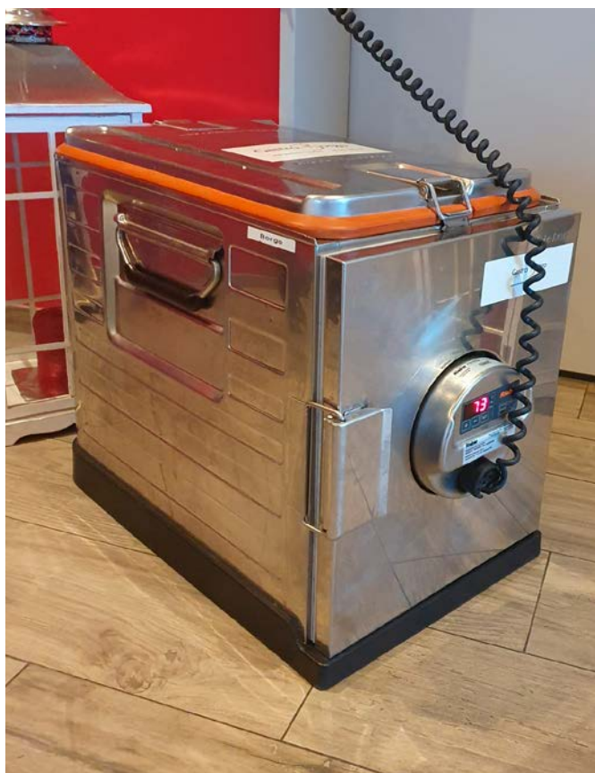
Wärmeschrank für den Transport der Mahlzeiten
